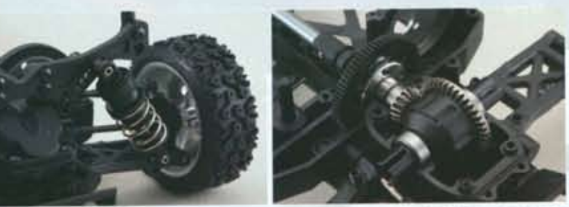
ストロークが十分に確保された金属ケースのオイルダンパー。前後ダンパーは高剛性な樹脂製となる。
