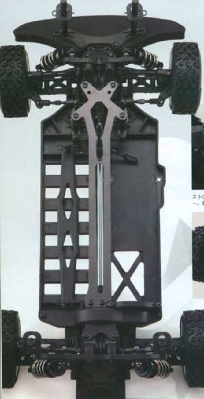
ストロークが十分に確保された金属ケースのオイルダンパー。前後ダンパーは高剛性な樹脂製となる。
