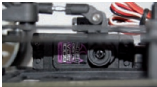
Das Lenkservo kommt liegend zum Einsatz, das senkt den Schwerpunkt
