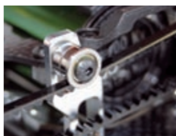
Der lange Hauptriemen wird durch eine verstellbare Rolle auf Spannung gehalten
