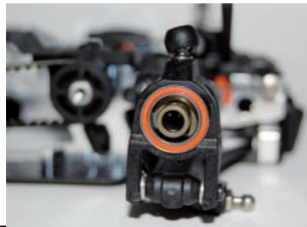
Gummigedichtete Kugellager kommen am gesamten Modell zum Einsatz
