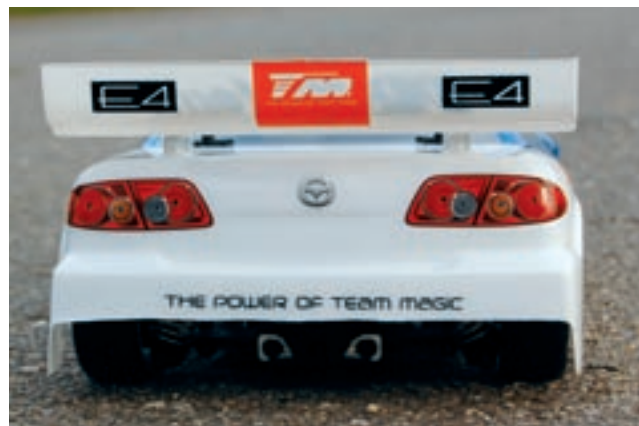
Gängige Tourenwagen-Karosserien verfügen über einen großen Flügel, der die Traktion der Hinterachse steigert. Das kam auch unserem Probanden zu Gute
