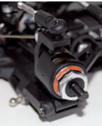
Ebenfalls aus Aluminium bestehen die Sechskant-Mitnehmer im gängigen 12-Millimeter-Maß
