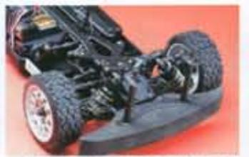
レイダウンされたアルミ製のダイヤフラム式ダンパーが低重心設計をさらに強調。シャフトドライブ4WDのスタンダードなデザイン
