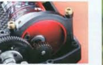
アルミ製の偏心式モーターマウントは、シャシーにクランプマウントされ、回転することでバッククラッチ調整が行える構造だ
